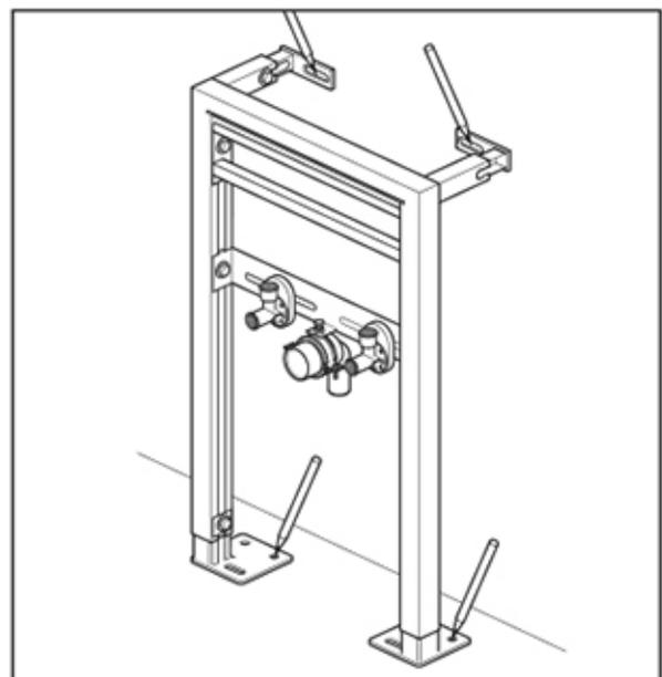
Markieren Sie die Befestigungspositionen an Wand und Boden. Entfernen Sie den Rahmen und bohren Sie die Löcher für die Halterungen vor. Befestigen Sie den Rahmen mit Schrauben und Dübeln an Wand und Boden. Überprüfen Sie, ob der Rahmen in alle Richtungen in der Waage ist.
