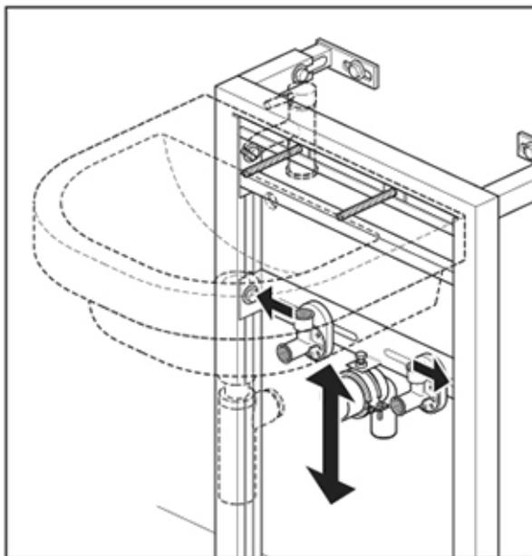
Setzen Sie das Waschbecken auf die vorbereiteten Gewindebolzen. Lösen Sie die Schrauben zur Einstellung der Verbindungshöhe und stellen Sie die Verbindungsstütze auf die erforderliche Höhe ein, um sie mit dem Abfluss auszurichten. Ziehen Sie die Schrauben an. Entfernen Sie das Waschbecken wieder.
