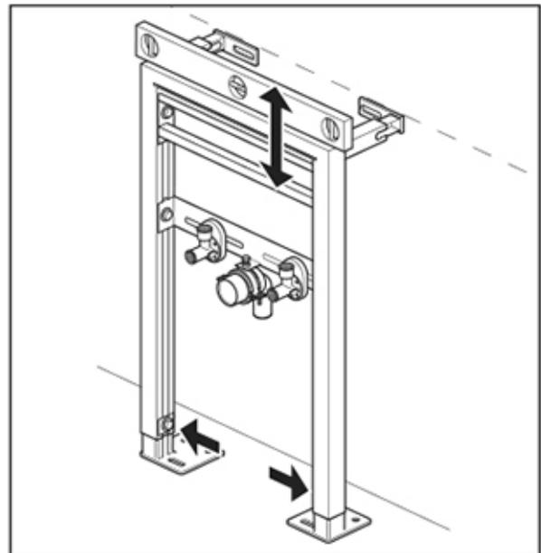
Stellen Sie den Rahmen in der geplanten Position an die Wand. Lösen Sie die Höhenverstellungsschrauben und stellen Sie die gewünschte Höhe ein. Prüfen Sie, ob der Rahmen horizontal in der Waage ist, und ziehen Sie die Schrauben fest.
