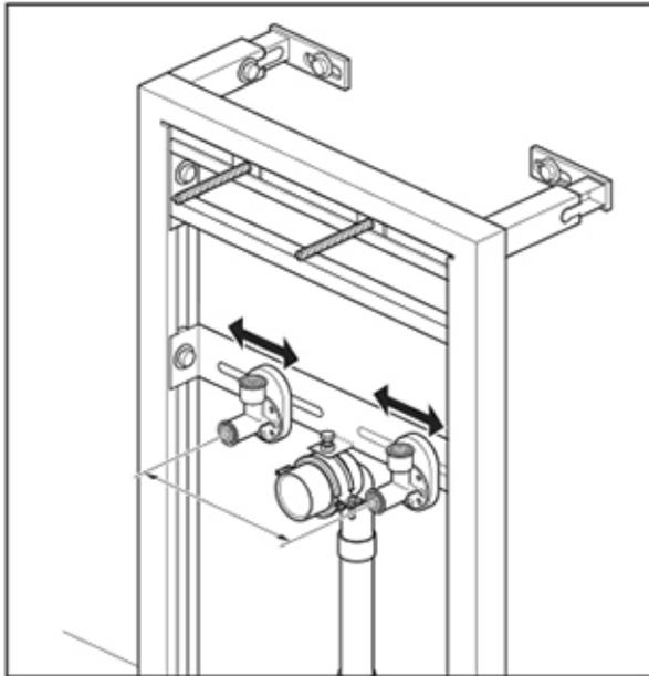
Lösen Sie die Zulaufanschlüsse für warm und kaltes Wasser (mit der hinteren Mutter). Stellen Sie den erforderlichen Abstand ein und ziehen Sie diese wieder fest.
