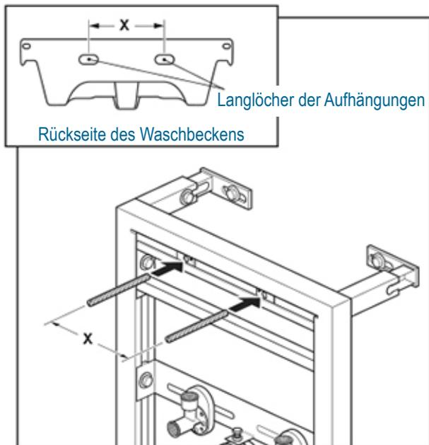
Den Abstand 'X' zwischen den Mitten der Langlöcher messen. Schrauben Sie die Gewindebolzen in die Gleitplatten. Zentrieren Sie sie mittig auf dem Rahmen und lassen Sie sie so weit auseinander, dass sie mit den Befestigungslöchern des Beckens übereinstimmen. Kürzen Sie die Gewindebolzen bei Bedarf.
