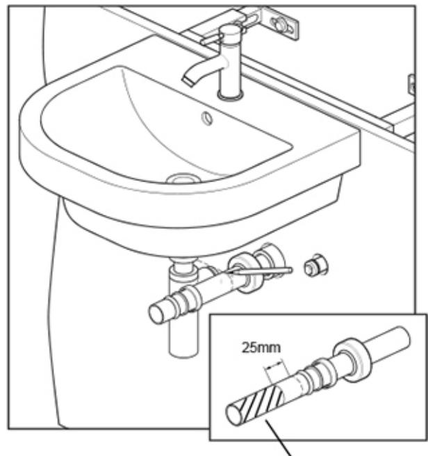
Positionieren Sie das Becken und markieren Sie das Ende des Ablaufrohres. Addieren Sie weitere 25 mm zur Längenmarkierung, kürzen Sie den Überstand. Stellen Sie sicher, dass das richtige Ende gekürzt und alle Grate entfernt werden. Setzen Sie das Ablaufrohr wieder in den Abflussbogen ein.
