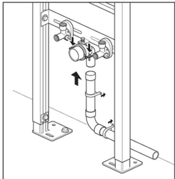
Bereiten Sie das Abflussrohr vor und schließen Sie es an (ein aufsteckbarer Abfluss wird empfohlen).
