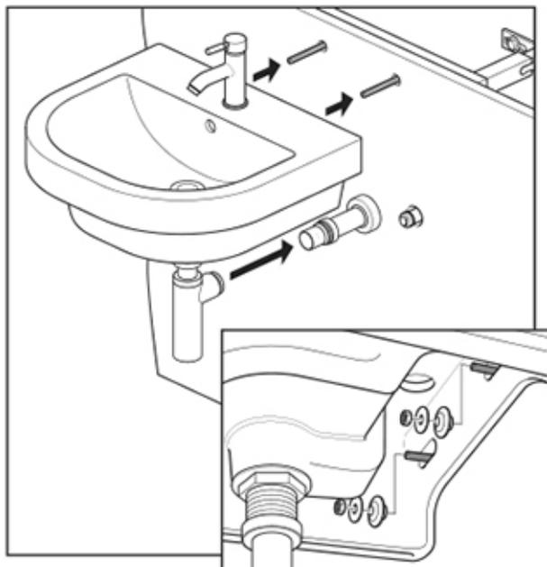
Positionieren Sie das Becken vorsichtig auf die Gewindebolzen und richten Sie den Ablauf aus. Setzen Sie die Kunststoff- und Metallscheiben unter dem Becken auf die Gewindebolzen und sichern Sie sie mit den Muttern.
