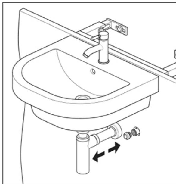
Befestigen Sie den Abfluss am Siphon und schieben Sie die Abdeckung darüber.
