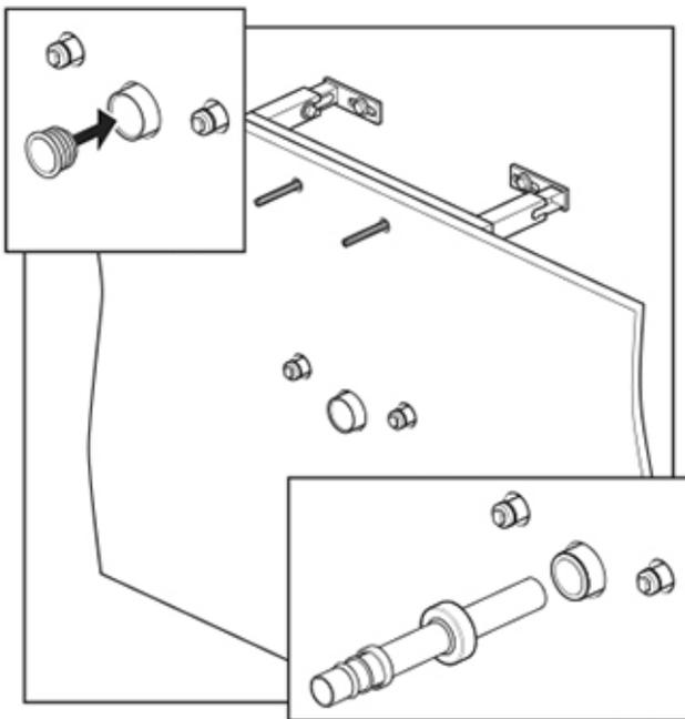
Stecken Sie die Ablaufdichtung in den Ablaufbogen. Stellen Sie die Trennwand und markieren Sie die Löcher für die Bolzen und Rohre so passgenau wie möglich. Wenn nötig, fliesen Sie die Oberfläche oder tragen Sie das Finish jetzt auf. Schmieren Sie die Innenseite der Abflussrohrdichtung und schieben Sie das Abflussrohr des Beckens in den Ablaufbogen.
