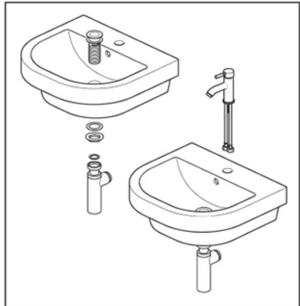
Befestigen Sie Ablauf, Siphon und die Armatur am Becken.
