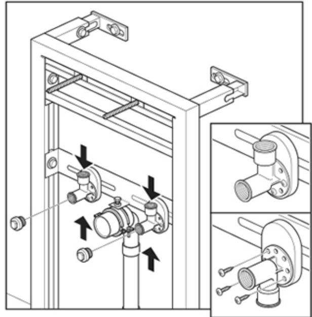
Verbinden Sie die Zuläufe der Warm- und Kaltwasserleitungen mit den Anschlussbogen (Ø 1/2"). Schrauben Sie die Blindstopfen in die Auslässe.
