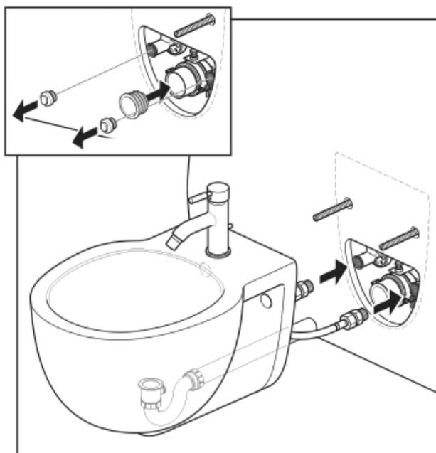
Positionieren Sie das Bidet vorsichtig auf die Gewindebolzen. Entfernen Sie die Blindstopfen und schließen Sie die flexiblen Warm- und Kaltzuläufe an. Für die Einlassbögen sind möglicherweise Adapter erforderlich. Schmieren Sie die Ablaufdichtung innen und schieben Sie das Ablaufrohr in den Ablaufbogen. Ziehen Sie alle Verbindungen fest an.
