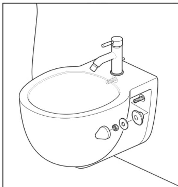
Positionieren Sie die Distanzhülsen und Unterlegscheiben vorsichtig auf den Bidet-Gewindebolzen. Ziehen Sie die Muttern an und platzieren Sie die Kunststoffabdeckungen.
