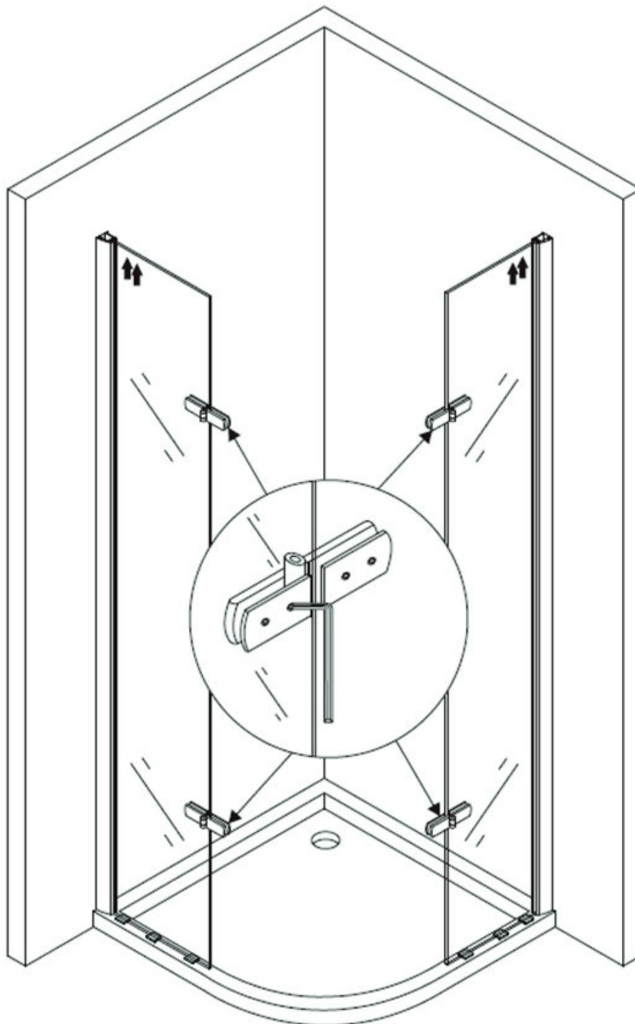
Befestigen Sie die Glastüren durch die Scharniere, setzen Sie die Magnet- und Gummileisten an die Glaselemente, wie unten auf dem Bild gezeigt.
