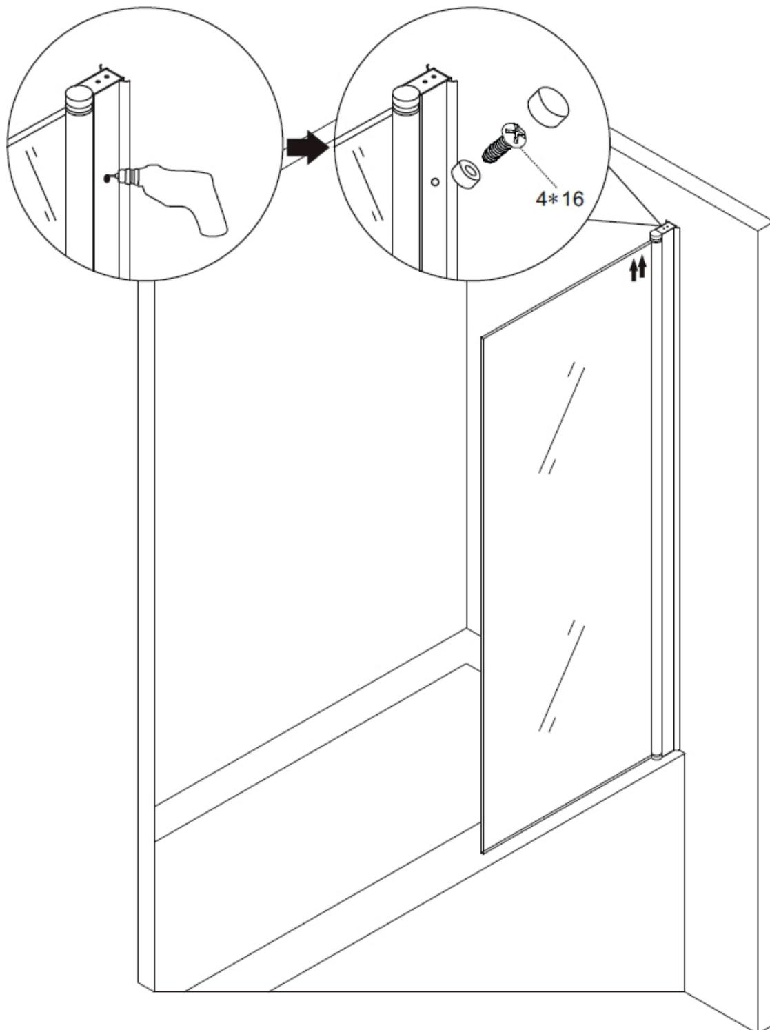
Installieren Sie die Scharniere an dem bereits montierten Glaselement.
