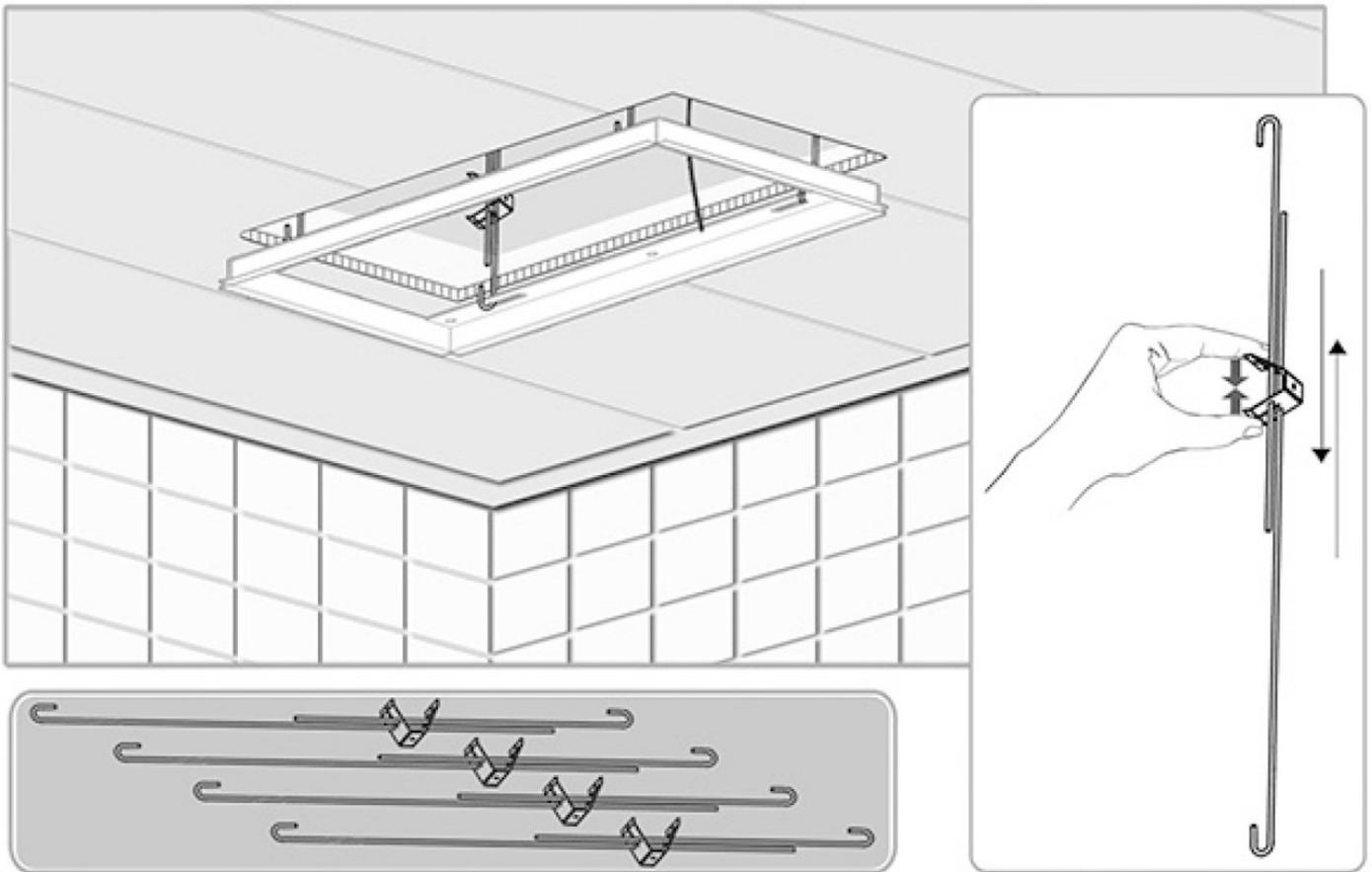
Installieren Sie die Aufhängung. Achten Sie darauf, dass die Aufhängung mit der Decke auf einer Höhe ist.
